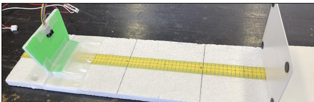
図7 測距用スライダ装置、スライダ、測距センサ設置図
