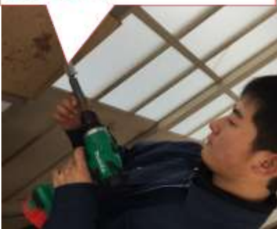
H30 凹状磁石でネジの向きが揃い、連射できるドライバー
